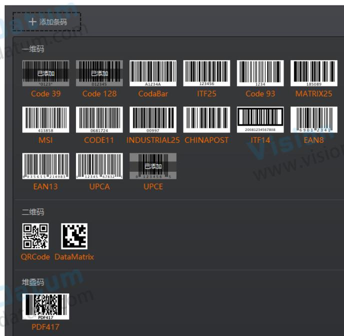
2. 选择设备需要读取条码的码制，可多选。此时算法配置界面显示已选择的码制，如下图所示。选择的码制越多，算法处理每张图片的耗时将增加，建议根据实际需求选择对应的码制，以达到最佳效果。
