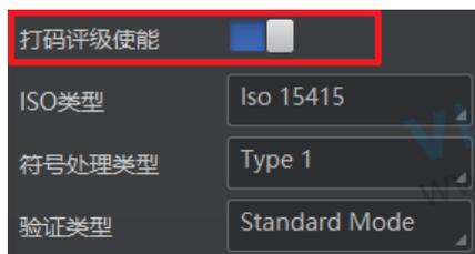
4. 通过“符号处理类型”参数设置打码评级处理类型，可选择 Type 1 或 Type 2。Type 1 对码的定位适应性相对较强，因此默认选择 Type 1。
