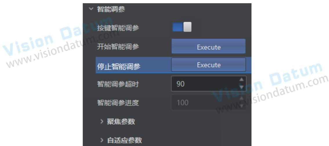
2. (可选) 通过智能调参超时参数，可设置智能调参超时时间。当自适应调节超过设定时间后将自动停止，同时提示调节超时信息。
