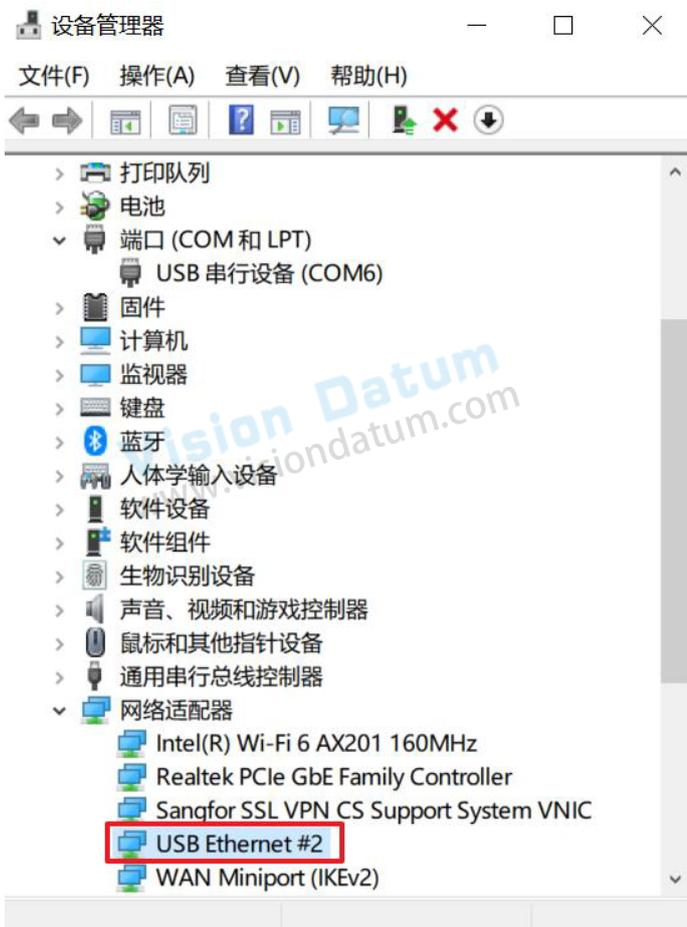
若 USB 驱动安装失败，如下图所示，可通过鼠标右键选择“更新驱动程序”重新安装驱动。
